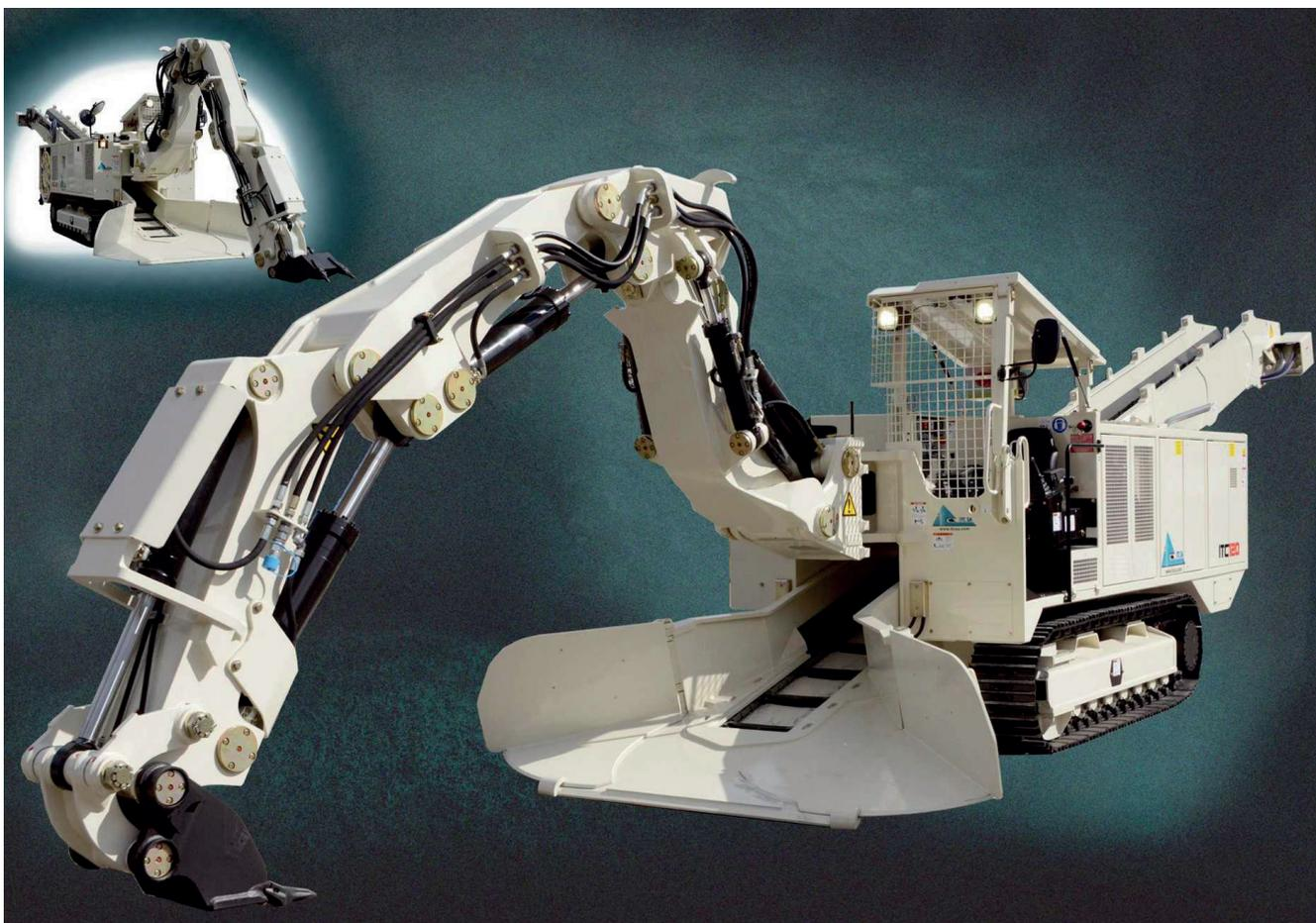
Для прокладки тоннелей в мягком грунте, профилирования и быстрой выемки взорванной породы.
